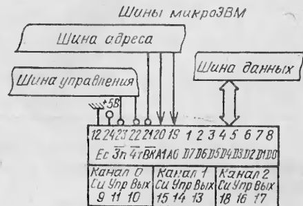
Рис. 1. Трехканальный таймер КР580ВИ53 (назначение выводов)
